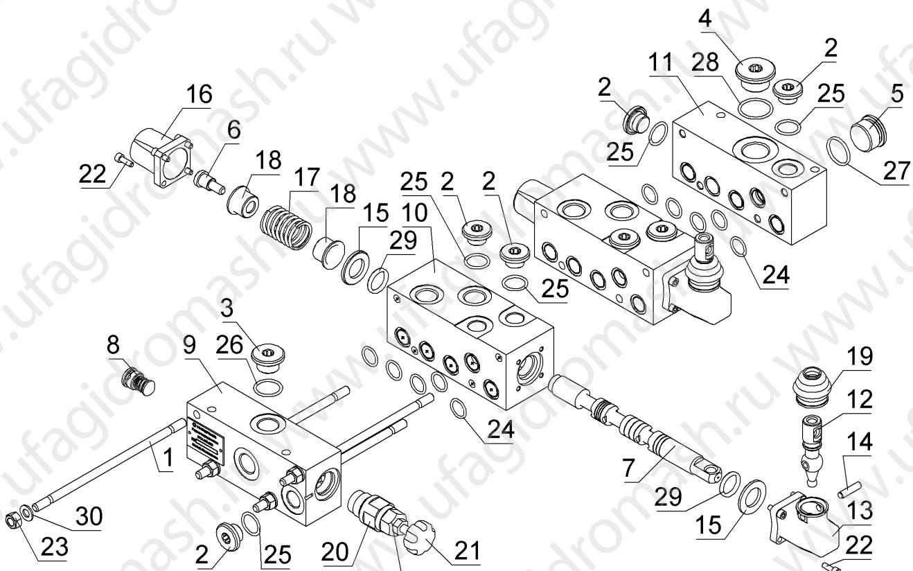
**Момент затяжки клапана - 42 Н·м**
